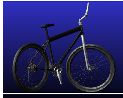
Figura 17. Simulación de la bicicleta en ADAMS/View.
