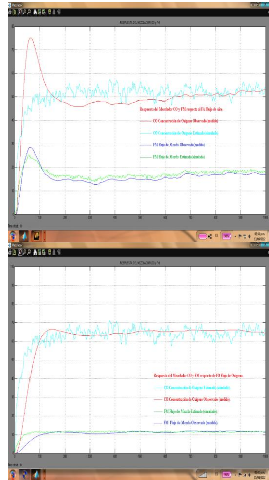
Figura 7. Respuesta en régimen permanente de los subsistemas del Mezclador.
