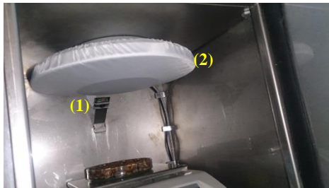
Fig. 8. Prototipo final en acero inoxidable. (1) cámara, (2) campana difusora
