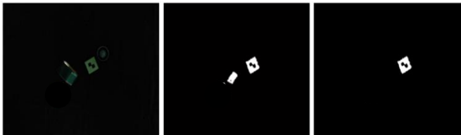
Figura 4. Eliminación de ruido. (a) Etiqueta pre-procesada. (b) Etiqueta umbralizada. (c) Etiqueta final, luego de eliminar ruido.
