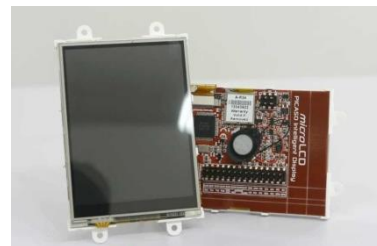
Fig. 6. Pantalla táctil 3.2" ref uLCD-32PTU
